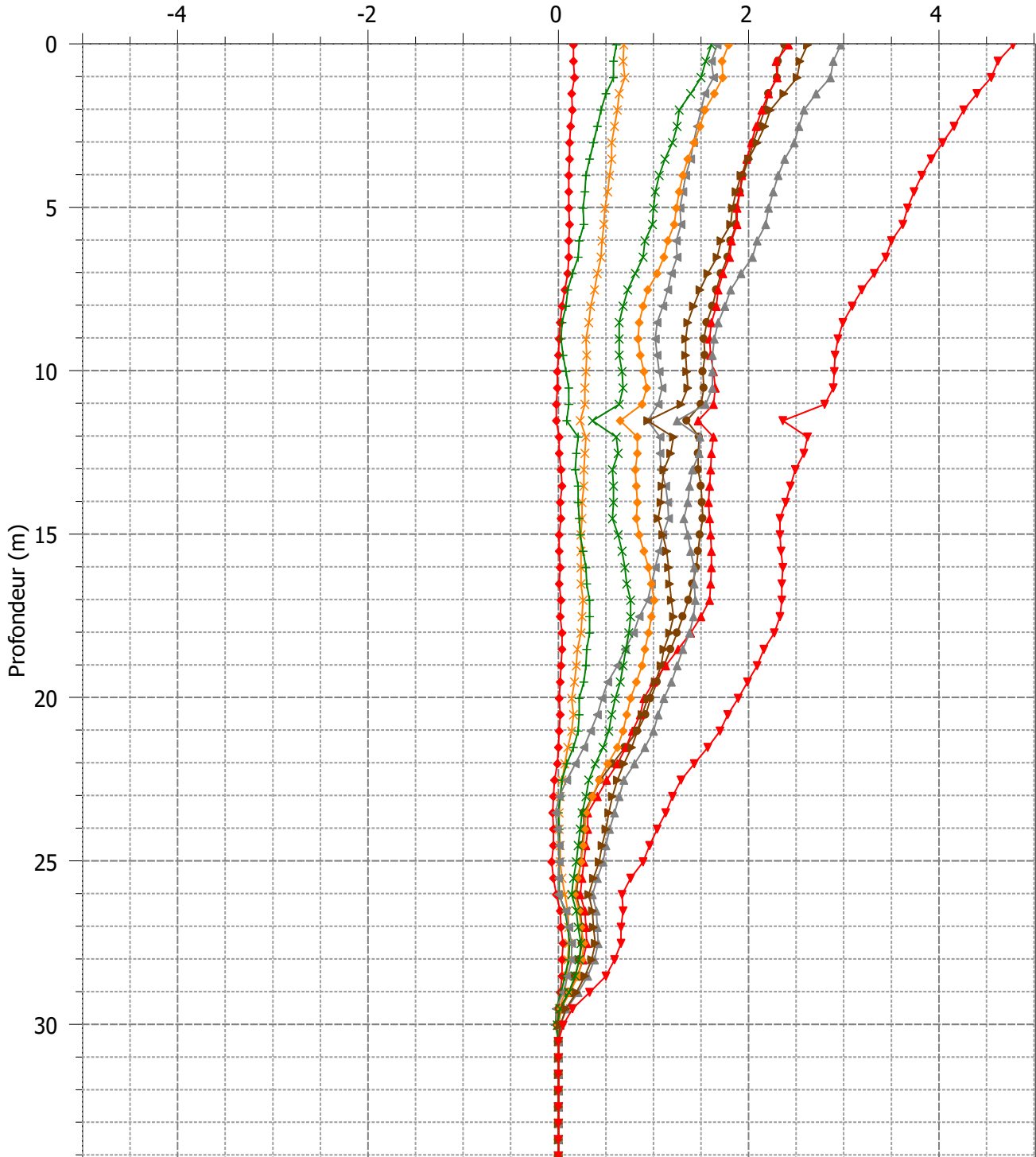
Evolution des déplacements relatifs cumulés (cm) - B1B2 (les déplacements positifs correspondent à un déplacement de B2 vers B1)
